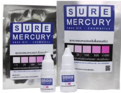
รูปที่ 3 ชุดทดสอบสารปรอทของคณะวิทยาศาสตร์ มหาวิทยาลัยมหิดล (5)
